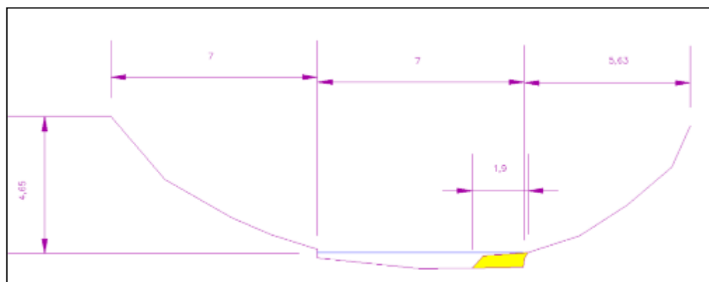
Figure 56 – Profil en travers projet avec banquettes basses.
