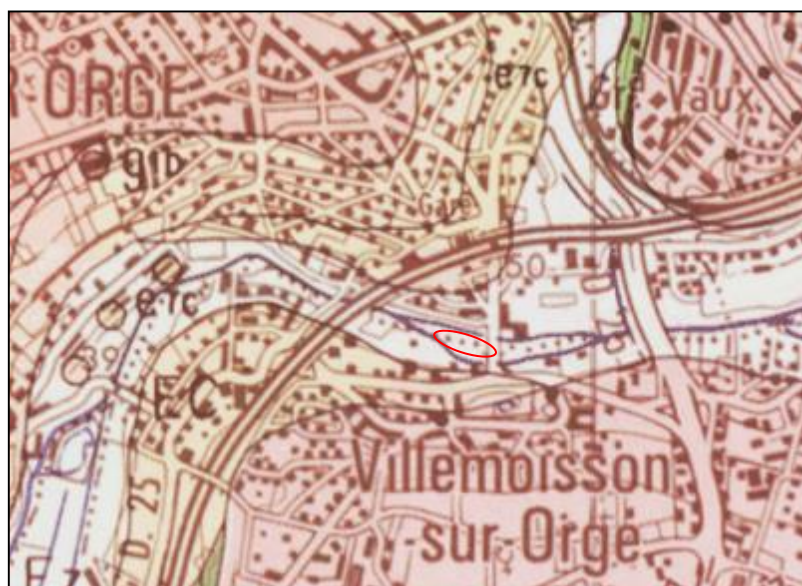
Figure 30 – Extrait de la carte géologique 50 000 ème et positionnement du tracé au sein des alluvions modernes.
