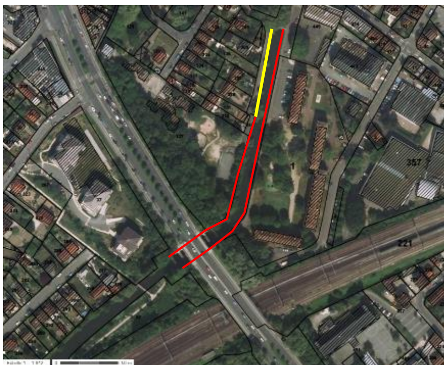
Figure 78 – Linéaire de berges maçonnées (en rouge) et naturelles avec cordon d'enrochements en pied de berges (en jaune).
