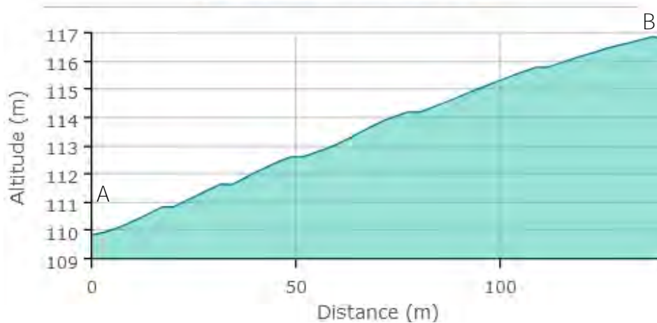
Figure 24 : Proposition du tracé du réseau d'eaux usées et présentation de la topographie du tracé (secteur 1)
