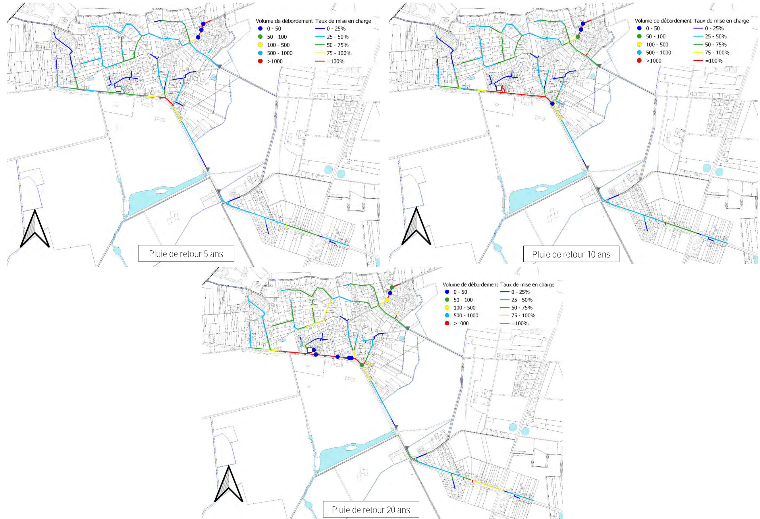
Figure 25 : Résultats des modélisations hydrauliques pour des pluies de retour 5 ans à 20 ans
