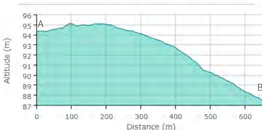
Figure 43 : Proposition du tracé du réseau d'eaux usées et présentation de la topographie du tracé (secteur 4)
